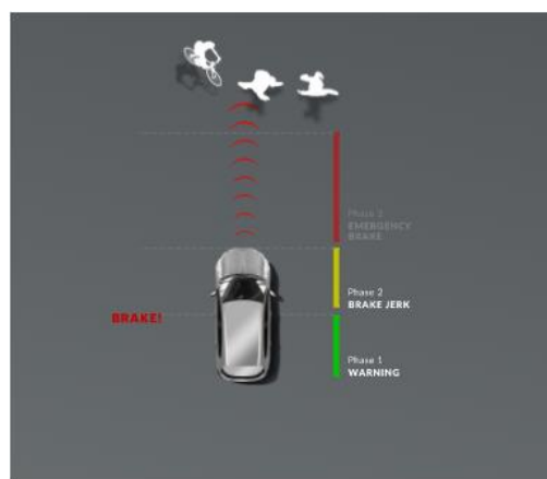
Автономне аварійне гальмування з радаром (місто/траса) (АЕВ)
